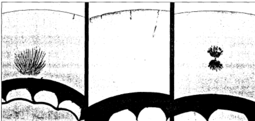
Slika 1. Oblike vodnih dreves »ventend tree« in »bow-tie tree«
